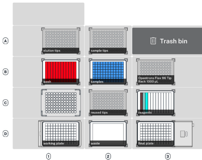
图 3. Opentrons Flex 自动化蛋白质纯化方案的甲板布局示意图。从同一细胞培养物收集的洗脱液经合并后, 进行 SDS-PAGE 及 Western blot 分析。结果显示目标蛋白成功富集(图 4 上图), 并证实了 mAb 的存在(图 4 下图)。
