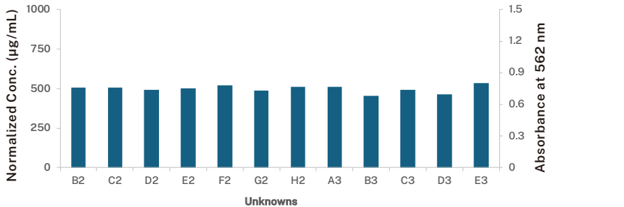
图 4: 样品归一化后使用 Opentrons Flex 板式吸光度读数器测量的蛋白质吸光度和浓度值。
