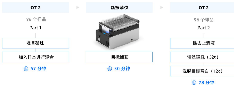
图1: Opentrons 蛋白质纯化工作站上基于 Ni-NTA 磁珠的蛋白质纯化工作流程概述
